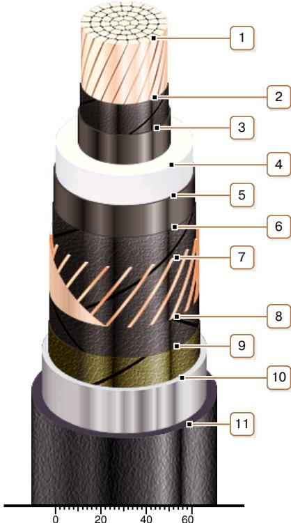
**1. Медная многопроволочная уплотненная токопроводящая жила**
