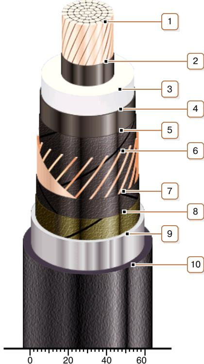
**1. Медная многопроволочная уплотненная токопроводящая жила**
