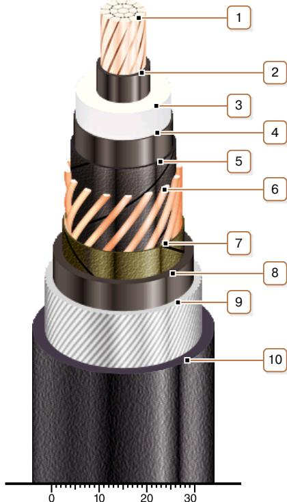
**1. Медная многопроволочная уплотненная токопроводящая жила**
