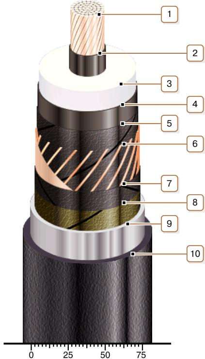
**1. Медная многопроволочная уплотненная токопроводящая жила**
