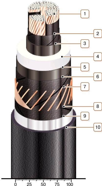
**1. Медная сегментная многопроволочная уплотненная токопроводящая жила**
