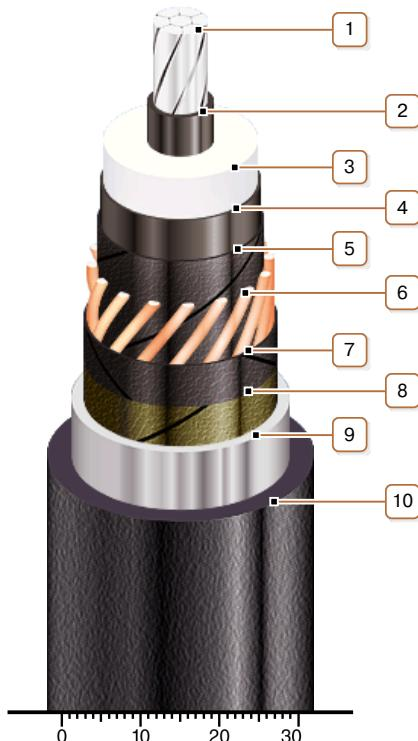
**КОНСТРУКЦИЯ****1. Алюминиевая многопроволочная уплотненная токопроводящая жила**
