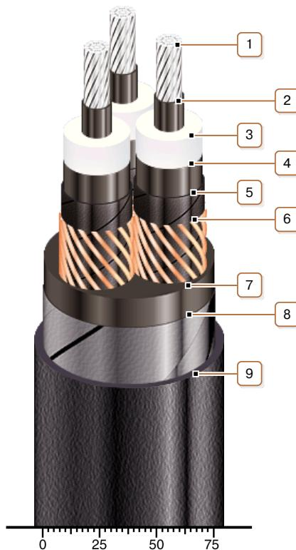
**КОНСТРУКЦИЯ****1. Алюминиевая многопроволочная уплотненная токопроводящая жила**
